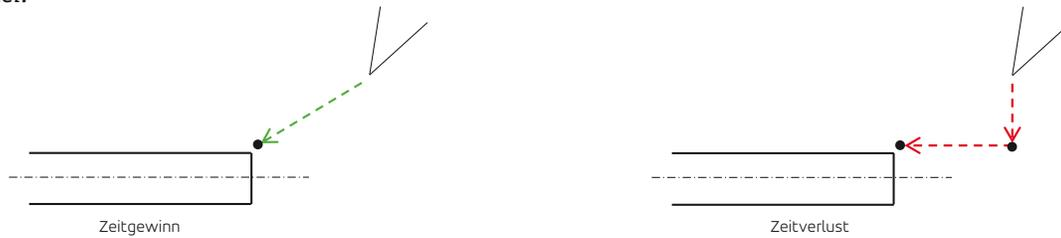
Die Werkzeugzustellung kann auch gleichzeitig in Richtung verschiedener Linear- und Drehachsen (z.B. YZ + C) ausgeführt werden.
