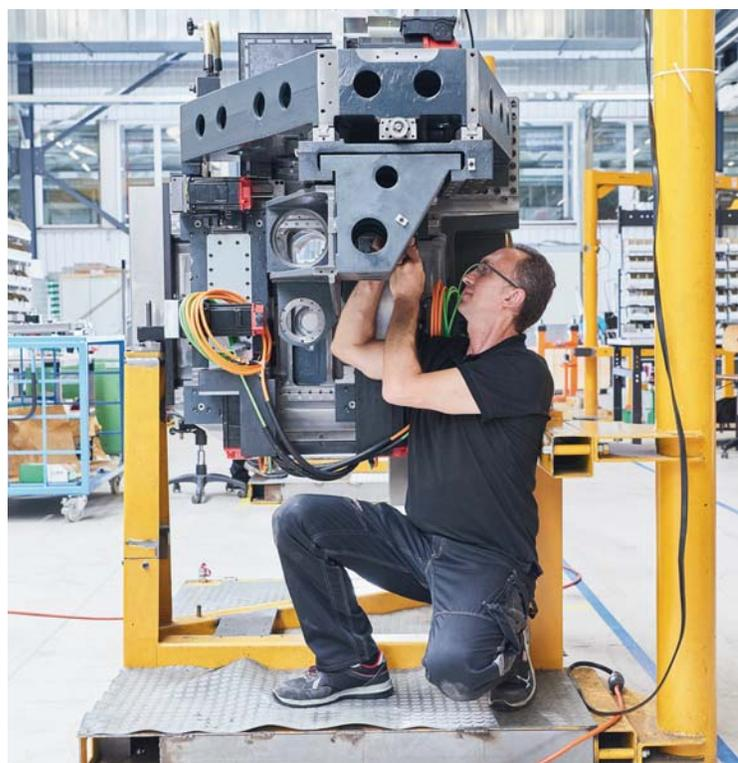
los parámetros finales. Esto se continúa con 50 horas de pruebas, la inspección geométrica y finalmente, la producción de una pieza de prueba que asegura que la máquina tiene el nivel de precisión y la repetibilidad necesarias.
