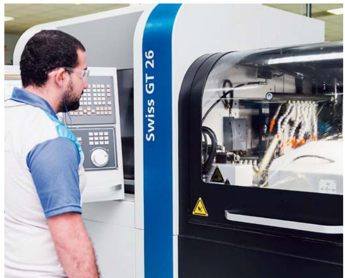
M. Leslie Bonilla, technicien machine, devant la Tornos Swiss GT 26; la machine est équipée d'un appareil à tailler.
