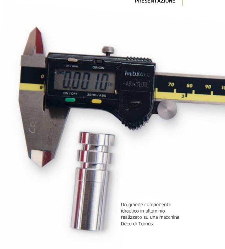
Un grande componente idraulico in alluminio realizzato su una macchina Deco di Tornos.
