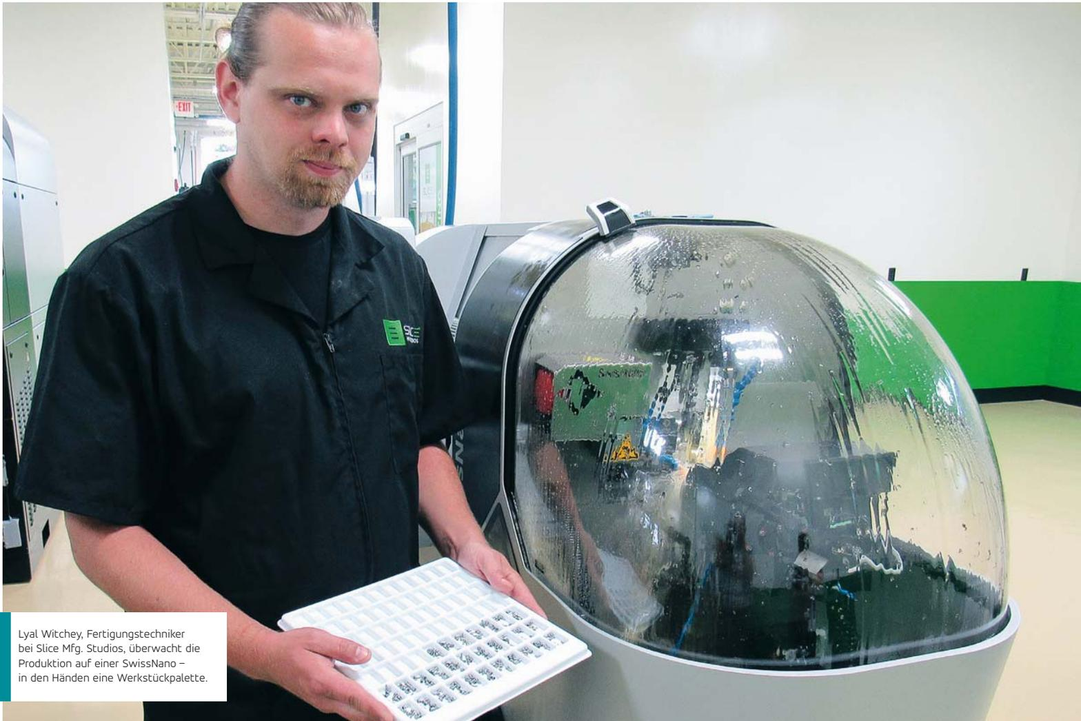
Lyal Witchey, Fertigungstechniker bei Slice Mfg. Studios, überwacht die Produktion auf einer SwissNano – in den Händen eine Werkstückpalette.
