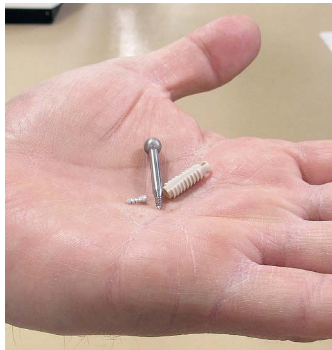
Parafusos ósseos de magnésio e titânio e protótipo de implante PEEK.
