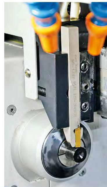
Swiss DT 26配置有5个直线轴和两个C轴，该机床另一个重要的特性就是还集成有压力为20巴的冷却装置，具有高压吹气功能。“Tornos将这些功能集成到Swiss DT 26中，而不是作为选配附件，不仅降低了机床的购买成本而且还减小了机床的占地面积。该机床集聚占地面积小、使用水溶性切削液等全面的综合功能等诸多优势，使我们的购买意向彻底转向了Tornos机床。虽然由于这些原因使我们更倾向于Swiss DT 26，但实际上该机床的易用性、机床运动学、工装配置、设置简单，以及Tornos提供的非常本地化的服务等这些优势也同时是我们购买的重要因素。”
