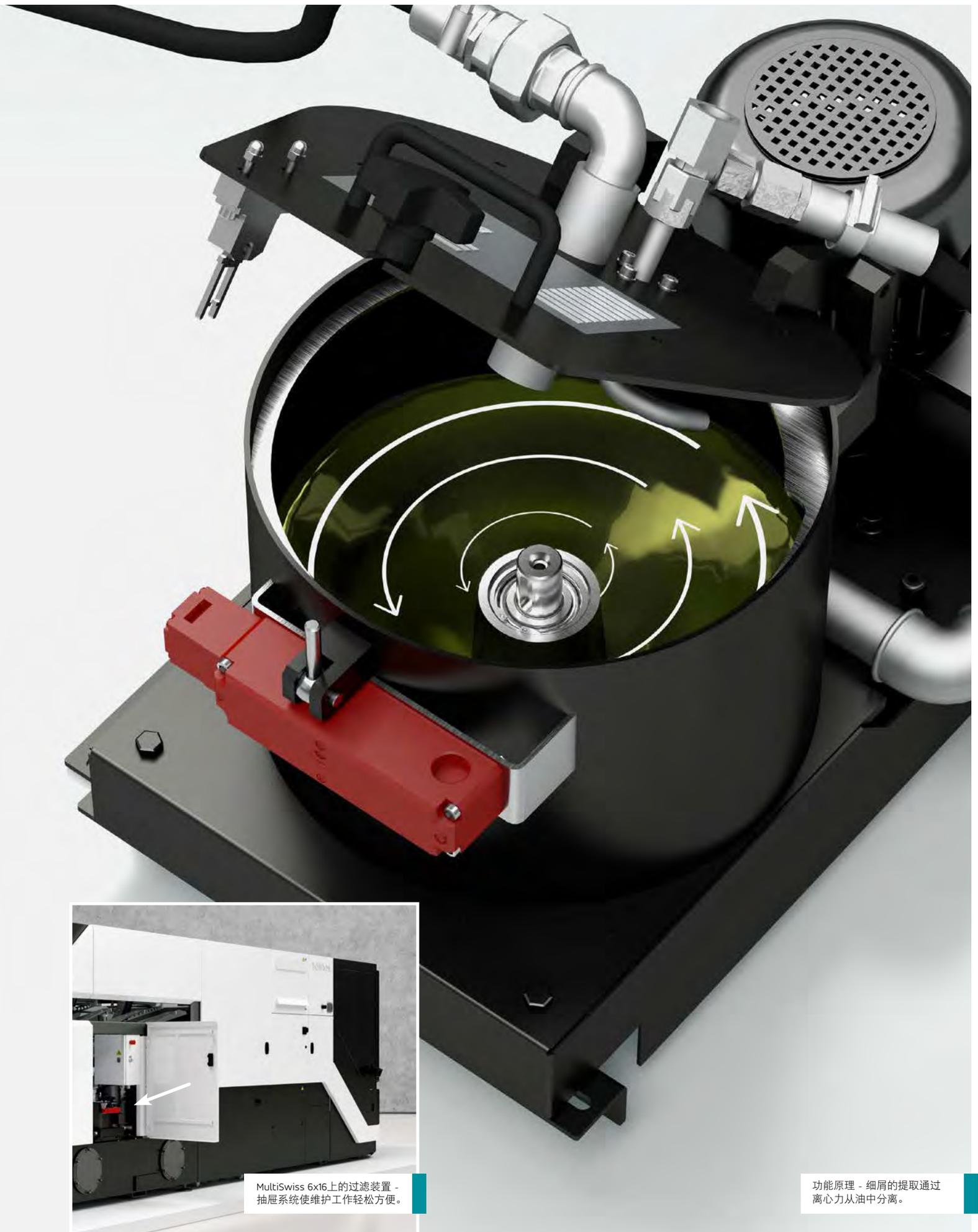
MultiSwiss 6x16上的过滤装置 - 抽屜系统使维护工作轻松方便。
