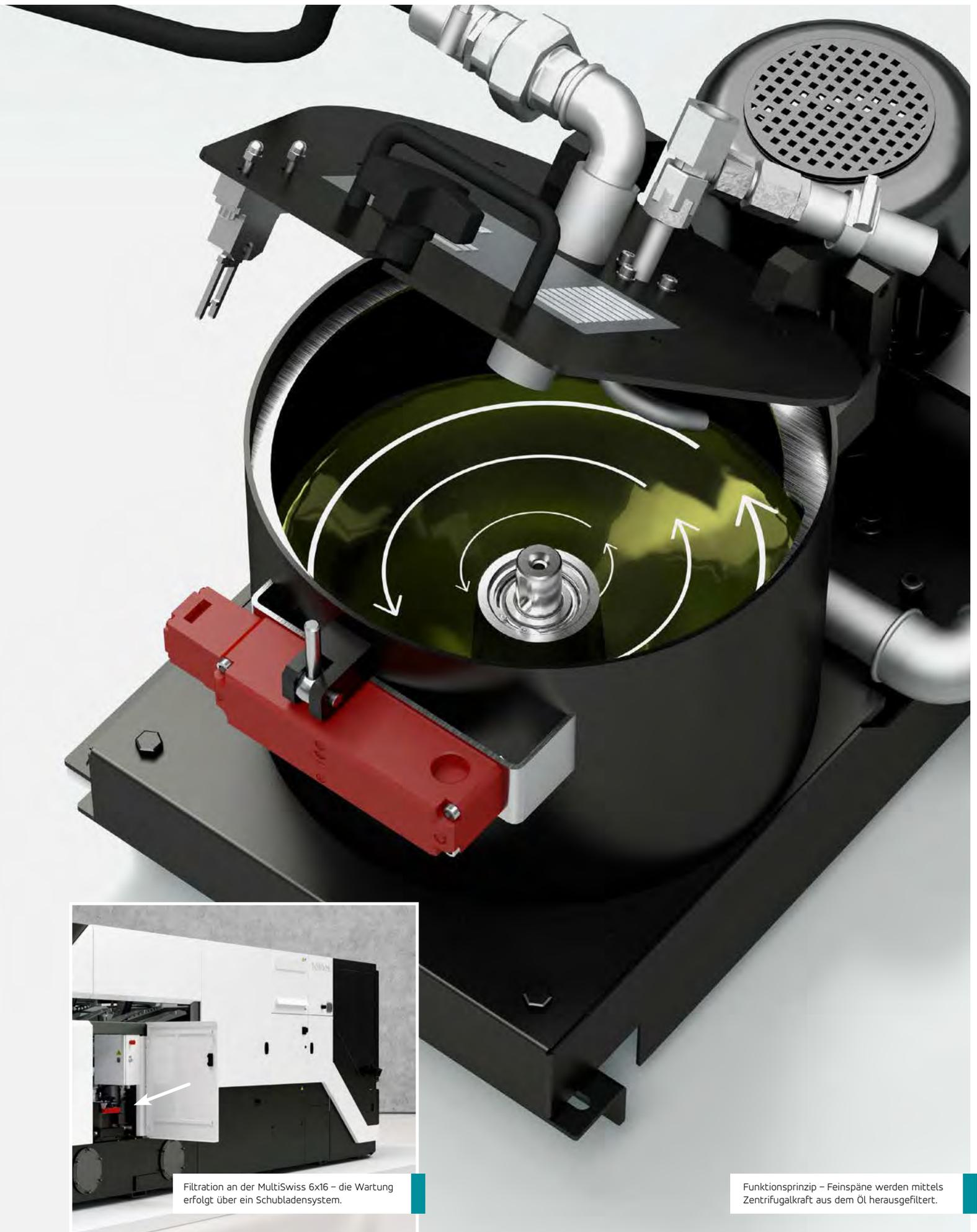
Filtration an der MultiSwiss 6x16 – die Wartung erfolgt über ein Schubladensystem.
