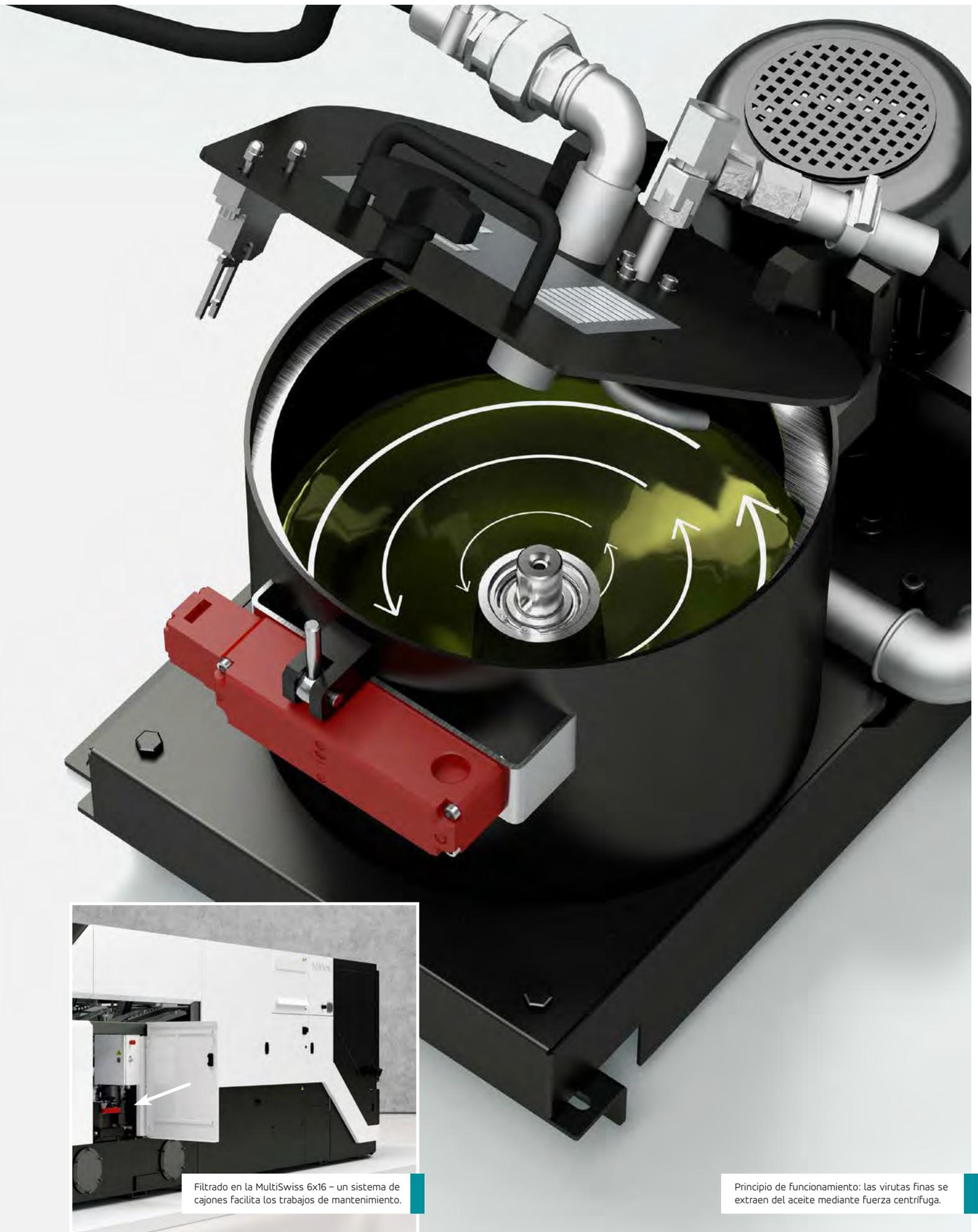
Filtrado en la MultiSwiss 6x16 – un sistema de cajones facilita los trabajos de mantenimiento.
