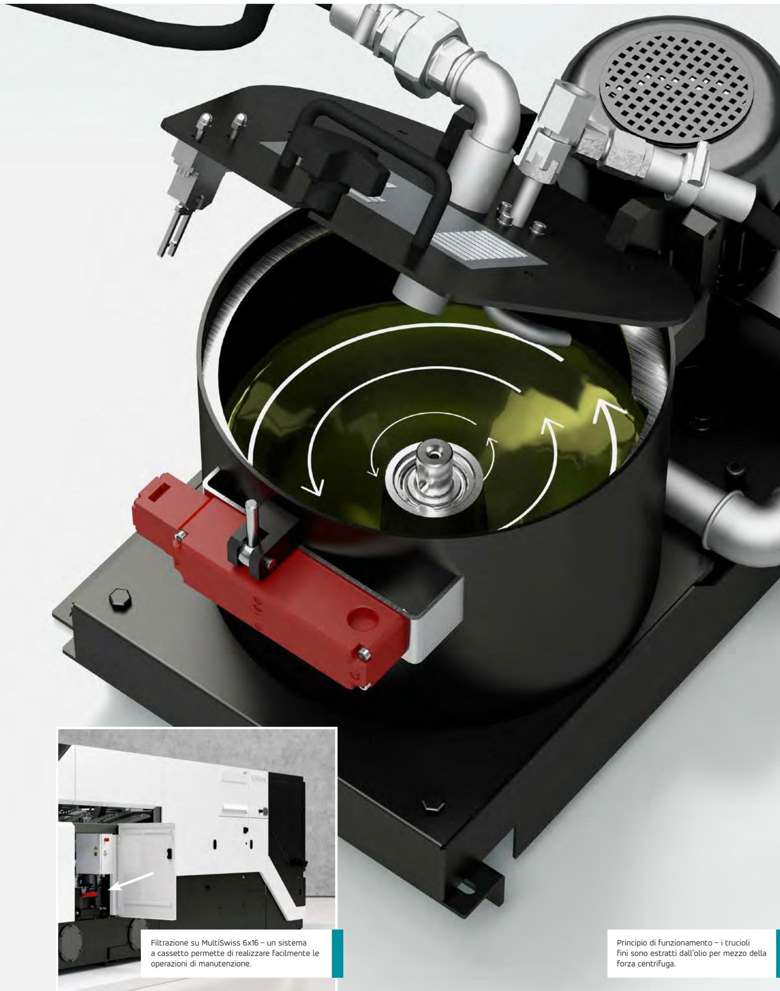
Filtrazione su MultiSwiss 6x16 – un sistema a cassetto permette di realizzare facilmente le operazioni di manutenzione.
