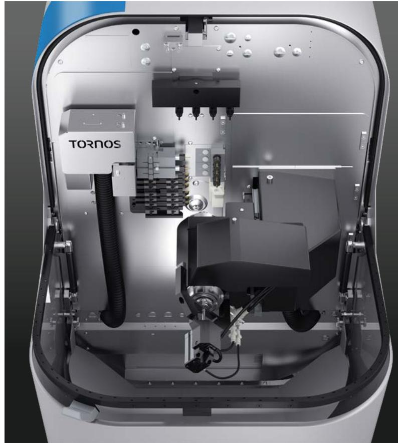
转盘无缝集成在SwissNano系列产品的外壳中，可根据现有机床进行调整。料斗采用编号管理；这种方法便于批量检查，还可根据特征进行工件分类（用于生产工件系列）。
