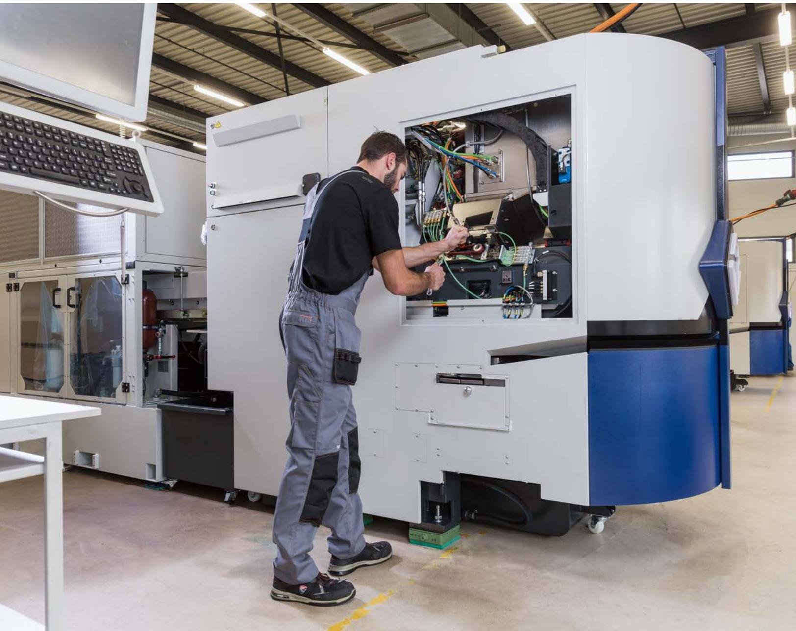
werden können“, erläutert Matthias Damman und spielt damit auf ein neues Tornos-System an, das jede Anforderung meistert. Mit dem Tornos-Spanbruchsystem, dem Active Chip Breaker, werden Späne kontrolliert gebrochen, so dass Maschinenausfälle aufgrund von Spananhäufungen verhindert werden.
