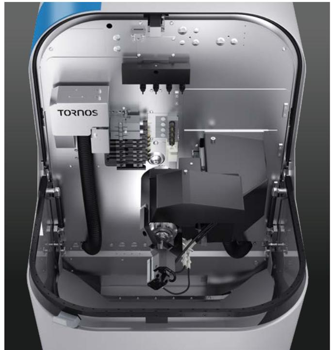
Manchmal reicht ein wenig Öl. Für diese Lösung ist das Karussell ausgelegt. In anderen Fällen kann oder muss das Karussell durch ein Vakuumsystem ergänzt werden. Tornos bietet dafür ein „hausgebautes“ Vakuumsystem an, eine sehr effiziente und wirtschaftliche Lösung für Kleinteile. Unser Team berät Sie bei der Auswahl des besten Systems und garantiert Ihnen ein optimales Preis-Leistungs-Verhältnis, basierend auf Ihrer Erfahrung und den Anwendungsbedingungen des Teils.
