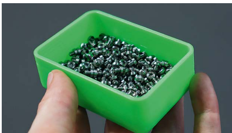
Grimsmos Swiss GT 13 kann praktisch alle Komponenten der Grimos-Messer herstellen – Drehgelenke, Gelenkschrauben, Lager, Schrauben, Distanzringe usw. – mit Ausnahme der Klingen und Griffe.
