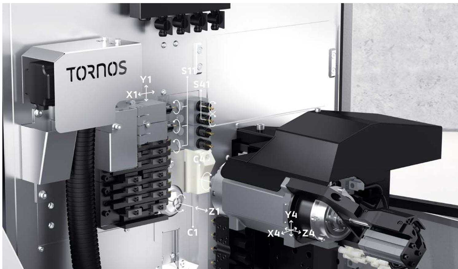
L'area di lavorazione sulla SwissNano 7 è accessibile da tutti i lati, il che rappresenta un enorme vantaggio in termini ergonomici.
