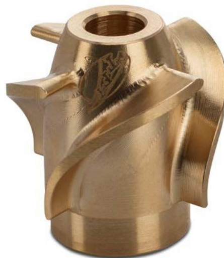
La Swiss ST 26, et une bonne gestion de la CFAO permet de réaliser des pièces d'une grande complexité, même sans axe B.
