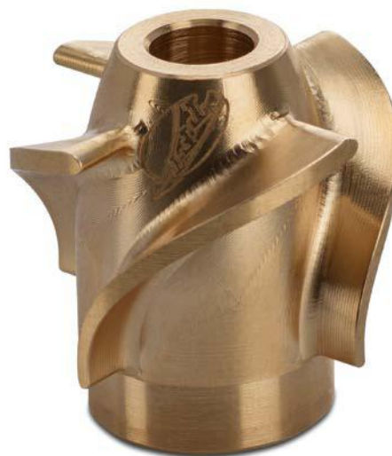
A Swiss ST 26 e o uso otimizado da tecnologia CAD/CAM permite que peças de trabalho altamente complexas sejam usinadas mesmo sem o eixo B.
