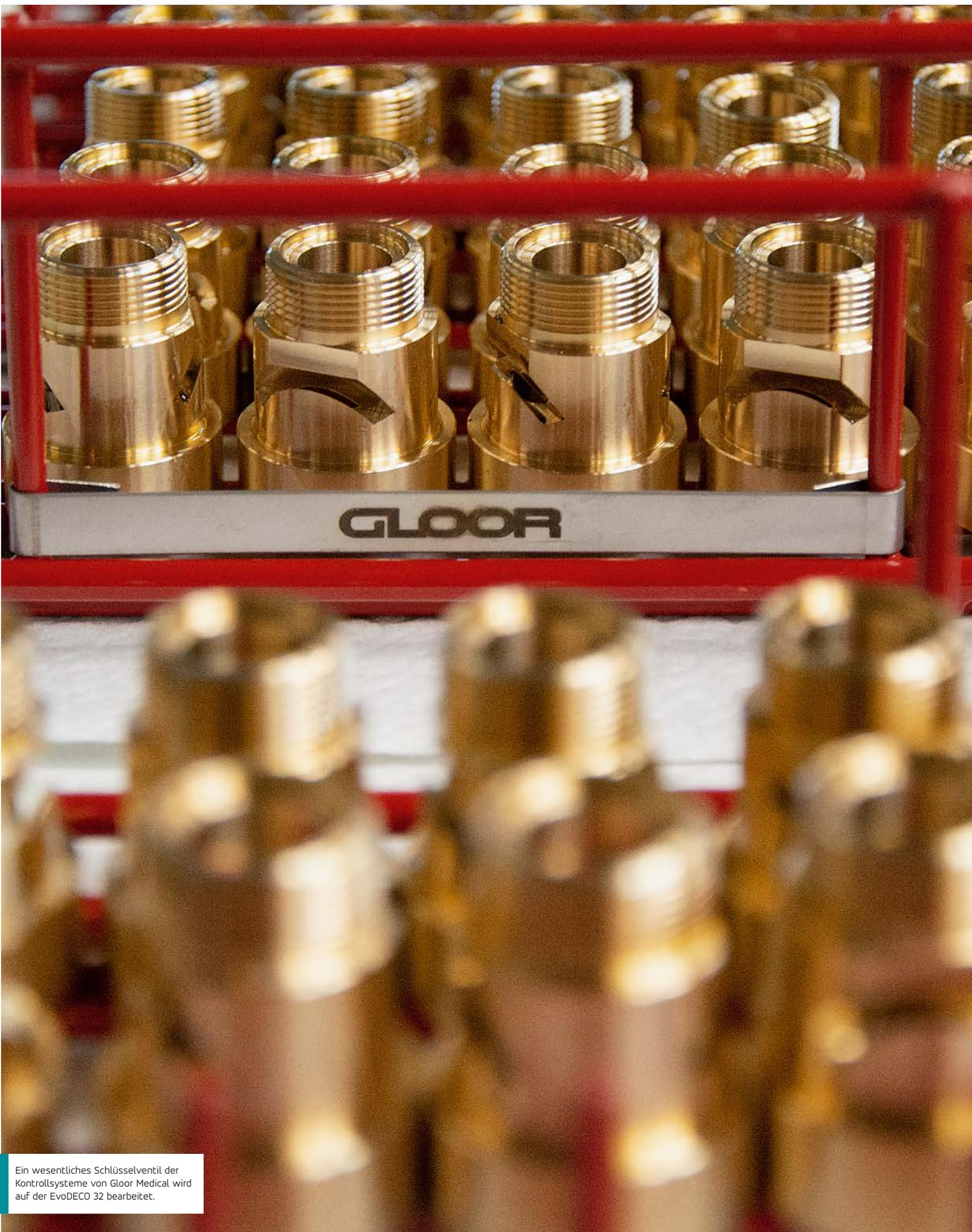
Ein wesentliches Schlüsselventil der Kontrollsysteme von Gloor Medical wird auf der EvoDECO 32 bearbeitet.
