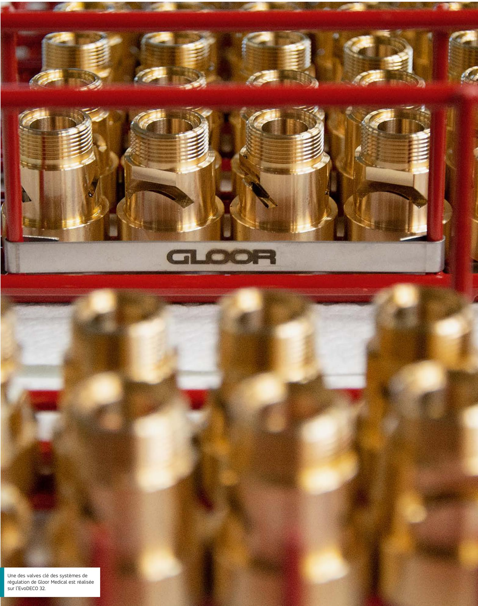
Une des valves clé des systèmes de régulation de Gloor Medical est réalisée sur l'EvoDECO 32.
