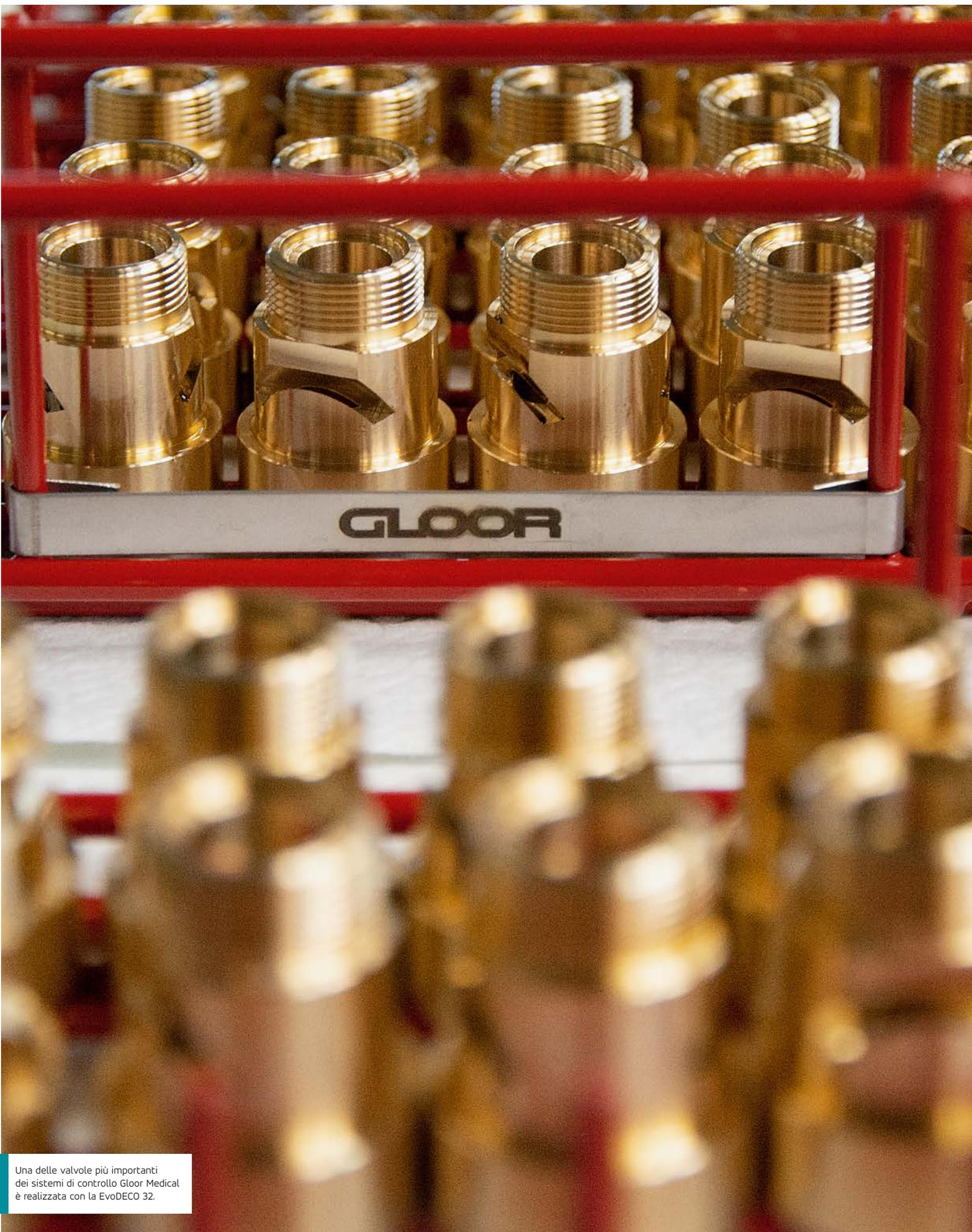
Una delle valvole più importanti dei sistemi di controllo Gloor Medical è realizzata con la EvoDECO 32.
