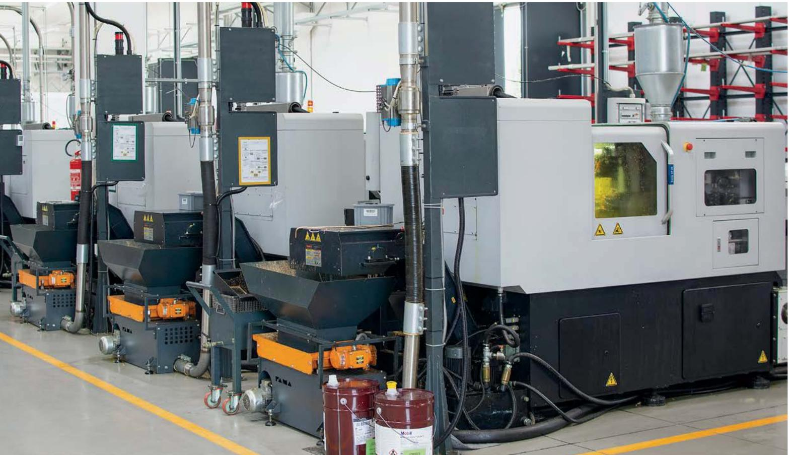
abierta y se ha optimizado para evitar la formación de un exceso de virutas. Asimismo, la máquina cuenta con cuatro sistemas de tratamiento del aceite de corte para poder mecanizar con total autonomía y sin ningún mantenimiento.
