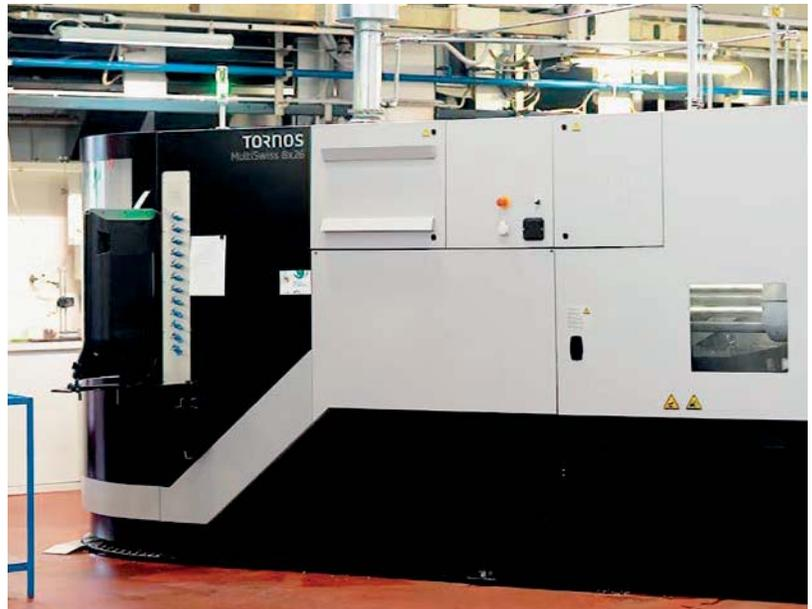
*trabalho de materiais resistentes, principalmente o aço inoxidável. As máquinas Tornos adquiridas pela empresa apresentam todas as funções para atender a essa exigência: rolamentos hidrostáticos e sistema de irrigação de alta pressão. Na prática, isso possibilita a produção de peças com tolerâncias estreitas.*
