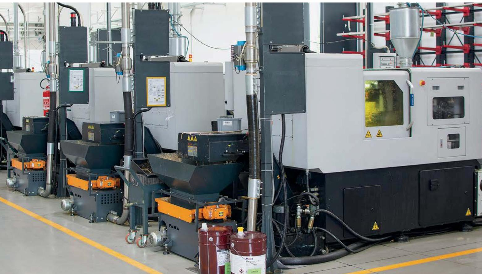
*Em particular, destacamos que a máquina MultiSwiss, trabalha principalmente com latão e realiza inúmeras operações de fresamento, produzindo cavacos muito pequenos. A área de usinagem da MultiSwiss é aberta e foi otimizada para evitar a formação de cavacos emaranhados. Além disso, a máquina está equipada com quatro sistemas diferentes de tratamento de óleo de corte, que permitem que ela trabalhe de forma independente, sem qualquer manutenção.*
