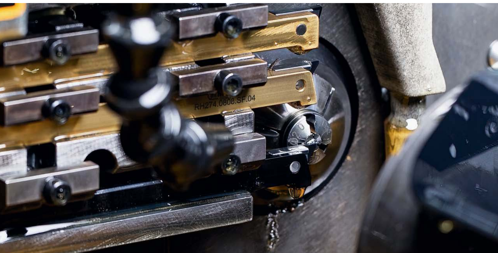
Aeschlimann采用S274系统进行纵向车削和开槽。
