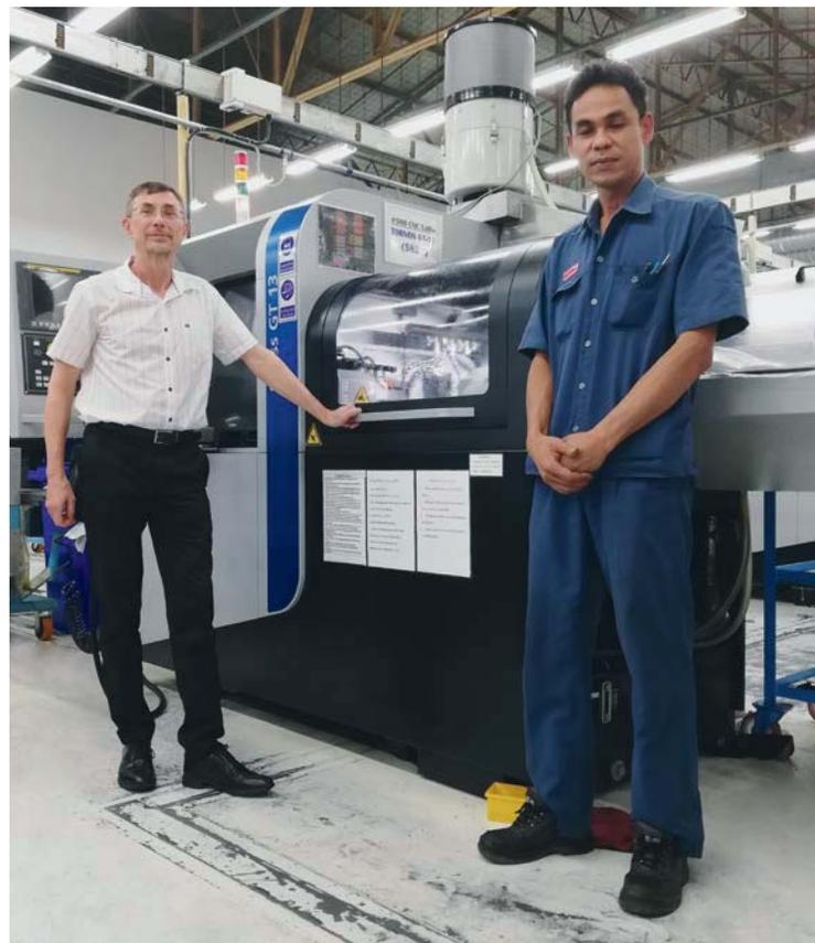
Manfred Schmid, Technical Support Manager, und Manu Meenak, Head of Maintenance, vor einer der Tornos Swiss GT 13-Maschinen, die z.B. für die Bearbeitung der Nadelstange eingesetzt wird, die für die genaue Positionierung der Nähnaedel entscheidend ist, um die legendäre Bernina-Stichqualität zu gewährleisten.
