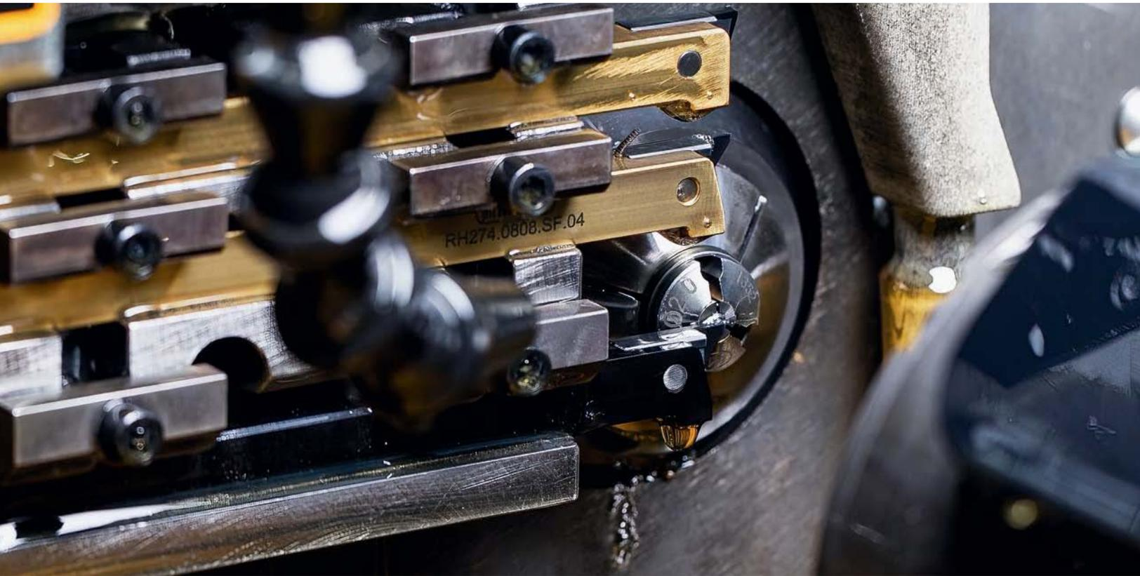
Beim Langdrehen und Einstechen setzt man bei Aeschlimann auf das System S274.
