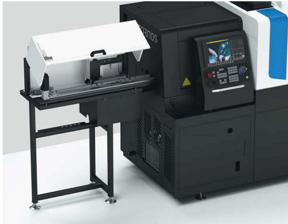
Die Rohrtelbeschickung ist in die Maschine integriert.
