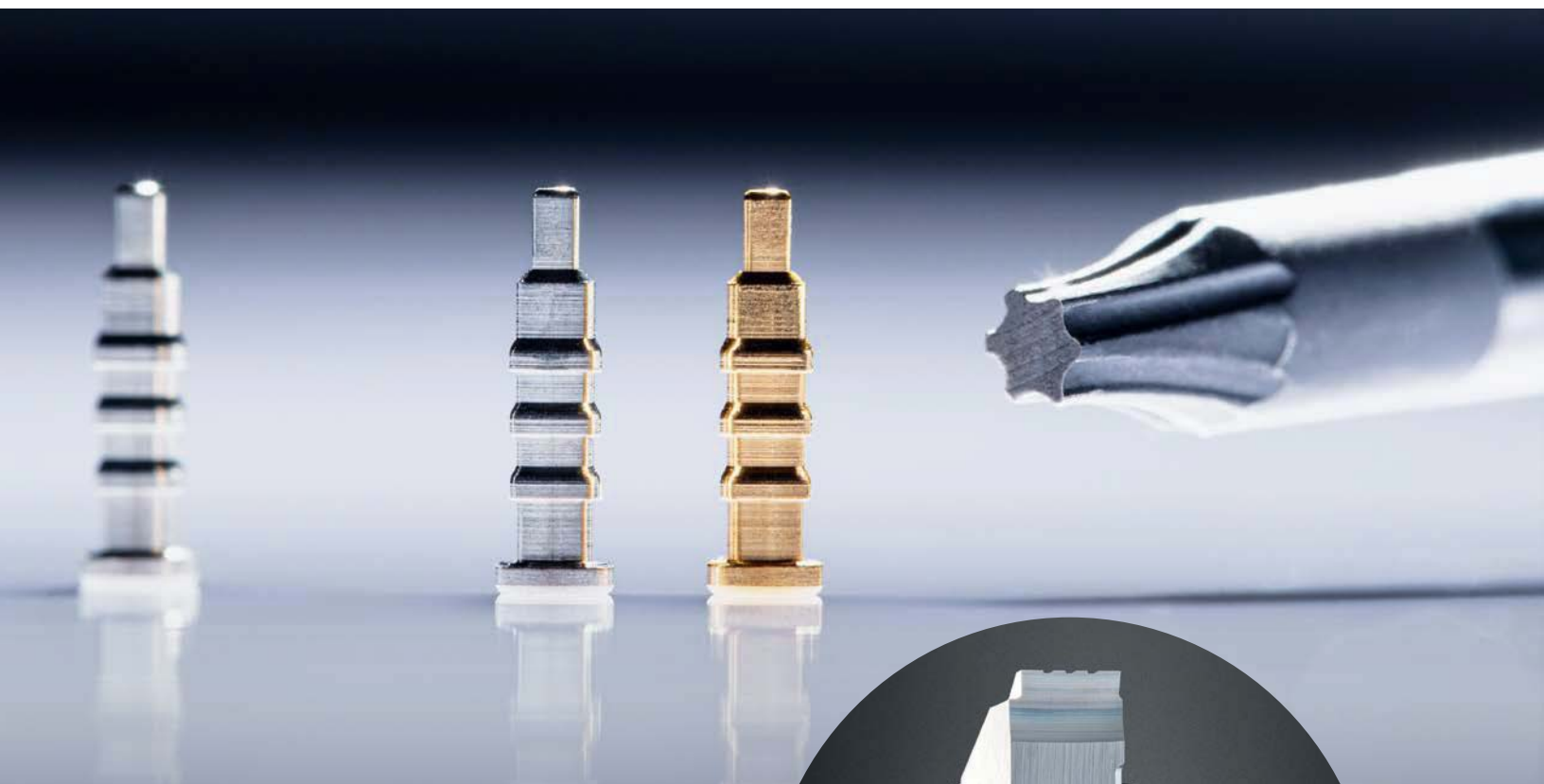
La pieza acabada, después de la fabricación (izquierda) y chapada en oro (derecha). El Torx Z7PL se muestra a efectos de comparación de tamaños.
