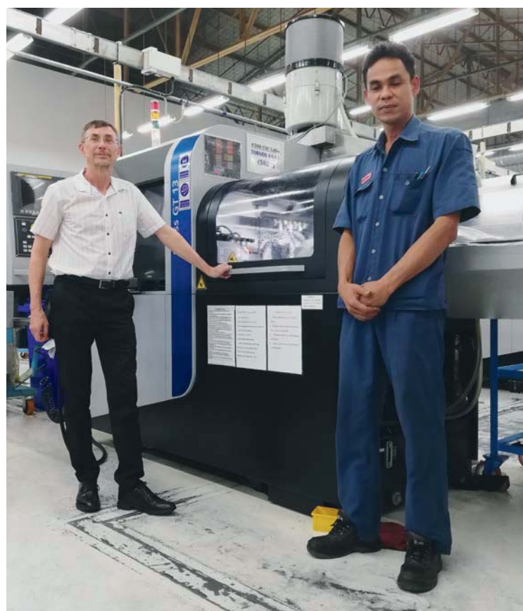
Manfred Schmid, director de asistencia técnica, y Manu Meenak, jefe de mantenimiento, delante de una de las máquinas Swiss GT 13 de Tornos utilizada, por ejemplo, para mecanizar la barra de agujas, crucial para el posicionamiento preciso de la aguja de coser, para garantizar la legendaria calidad de puntada de Bernina.
