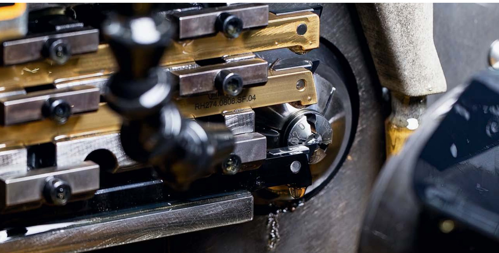
Aeschlimann emplea el sistema S274 para cilindrar y punzonar.
