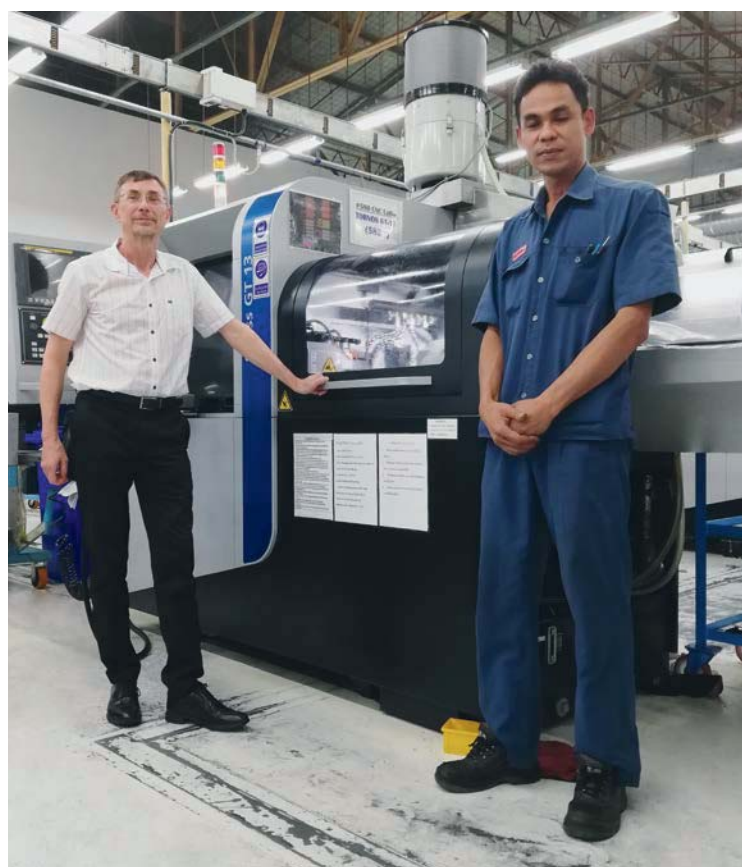
Manfred Schmid, Gerente de Suporte Técnico, e Manu Meenak, Chefe de Manutenção, em frente a uma das máquinas Tornos Swiss GT 13 utilizadas por exemplo, para usinar a barra de agulha, que é crucial para o posicionamento preciso da costura, para garantir a lendária qualidade dos pontos da Bernina.
