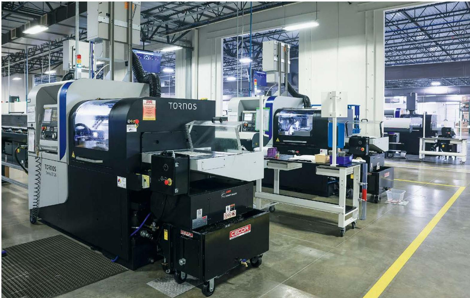
Chris Weeden, précisant que la plupart des pièces usinées à Memphis sont en acier inoxydable et mesurent entre 150 et 460 mm de long et entre 0,39 mm et 20 mm de diamètre. «La machine DECO a exaucé le moindre de nos souhaits. J'ai toujours aimé la programmation TB-DECO. On peut écrire un programme et le logiciel TB-DECO permet de poser des questions, donc un programme peut renfermer 20 numéros de pièces d'une même famille.»
