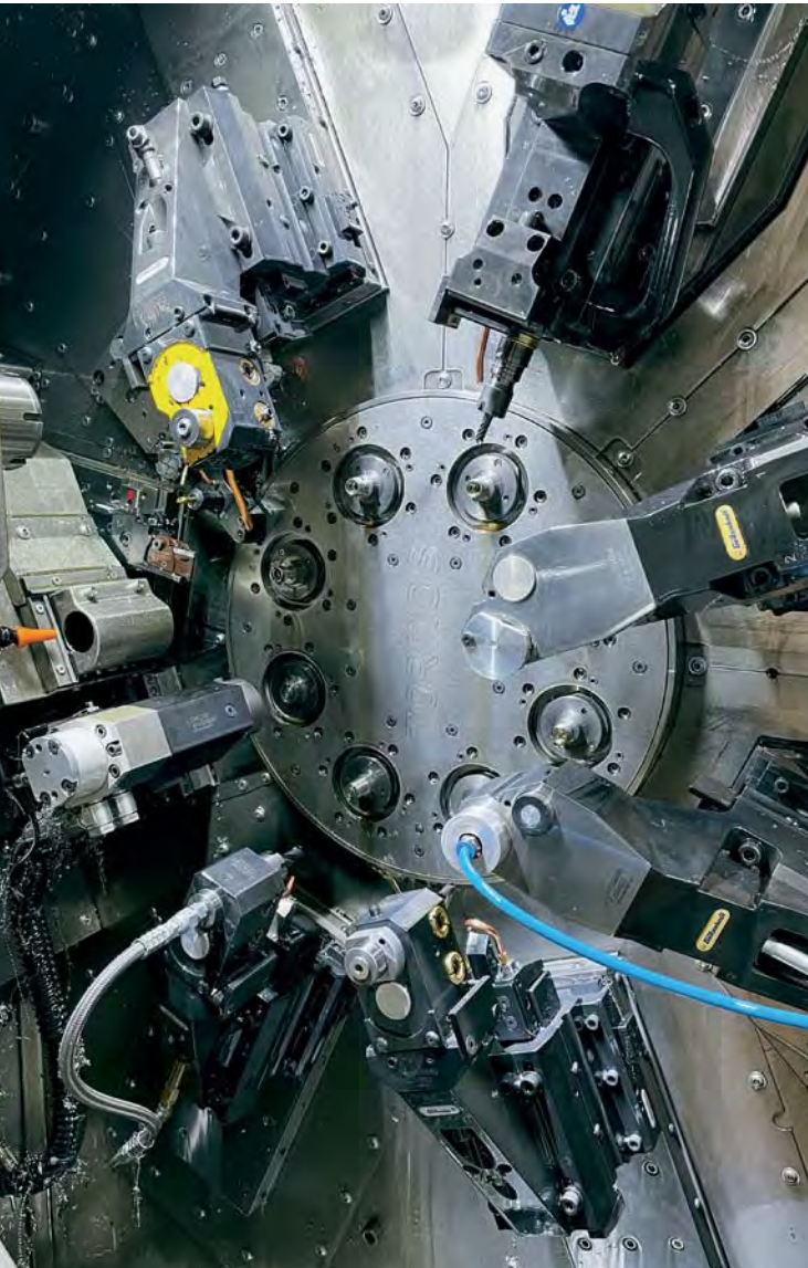
工场选择了具有26 mm棒材能力的8轴机床, 确信其配置能够为所加工的复杂零件提供尺寸与速度的最佳组合。目前正在设法精简外部冷却管道并使机油直接流经刀具, 从而进一步加快工件装夹转换速度。
