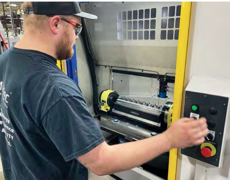
Dank der CNC-Mehrspindelmaschinen konnte Zeit für die vier Vertikal-Fräsmaschinen gewonnen werden, die zuvor hauptsächlich für Nachbearbeitungen verwendet wurde. Maschinen wie diese Brother VMC mit Palettenwechsler und hydraulischer Werkstückaufnahme werden jetzt für die Produktion eingesetzt.
