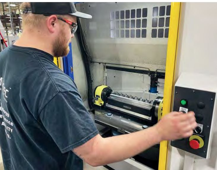
I multimandri CNC hanno liberato del tempo sulle quattro VMC di Mitotec Precision che in precedenza erano utilizzate principalmente per il lavoro di ripresa. Ora l'officina utilizza per la produzione macchine come questa VMC Brother con cambio pallet e serraggio pezzo idraulico.
