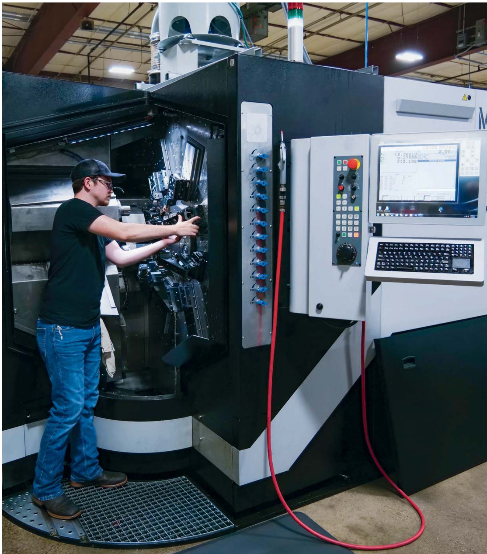
Jako zakład produkcyjny Mitotec Precision nadal bada sposoby przyspieszenia przezbrajania zadań, które są wykonywane przez dwie wielowrzecionowe tokarki CNC, dla operatorów takich jak Trevor Hutchins, wcześniej praktykant, a teraz pracownik. Wielkość partii 20000 części to złoty środek w przypadku tych maszyn. (Photo Credit: Mitotec Precision)
