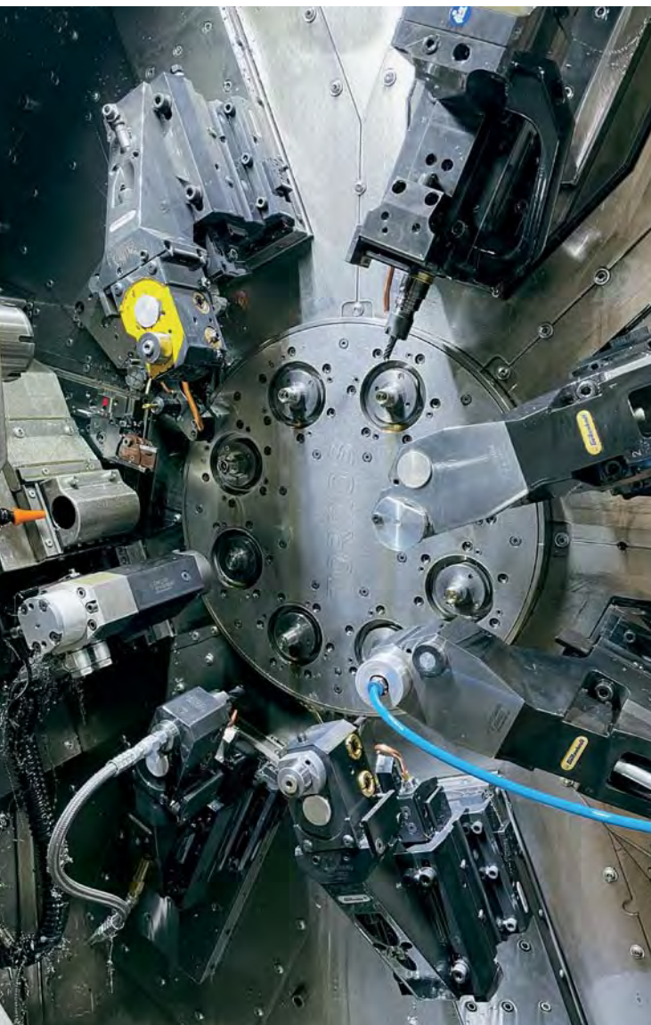
Zakład wybrał 8-wrzecionowe obrabiarki z maks. średnicą pręta 26-mm, wierząc, że ta konfiguracja oferuje właściwą kombinację rozmiaru i prędkości dla części złożonych, które będą przez nie przechodzić. Prowadzi też prace nad eliminacją zewnętrznych linii chłodzenia, które zastąpi system przepływu oleju przez narzędzia, aby jeszcze bardziej przyspieszyć przezbrojenia.
