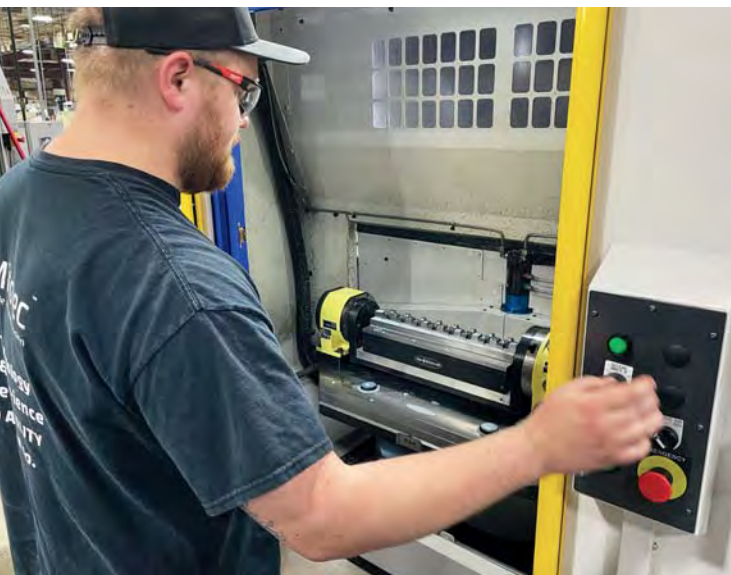
Wielowrzecionowe maszyny CNC stworzyły możliwości dla czterech obrabiarek VMC Mitotec Precision, które wcześniej były używane głównie do drugorzędnych operacji. Obecnie zakład wykorzystuje do prac produkcyjnych maszyny takie jak obrabiarka Brother VMC ze zmiennym palet i hydraulicznym mocowaniem.
