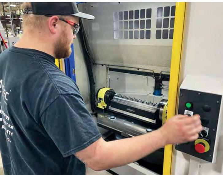
O multifusos CNC abriu tempo nos quatro VMCs da Mitotec Precision que anteriormente eram usados principalmente para trabalhos de segunda operação. Agora, a oficina está utilizando máquinas como esta Brother VMC com trocador de paletes e porta-peças hidráulico para trabalhos de produção.
