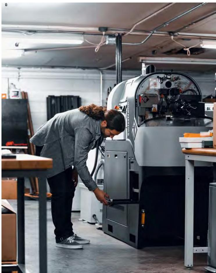
*agora. Agora sou só eu que comando as máquinas para fabricar nossas peças, então estou me concentrando fortemente no uso da melhor tecnologia possível, como o alimentador de barras em ambas as nossas máquinas Tornos para que eu possa apenas programar a máquina, ligá-la, e ela possa funcionar*
