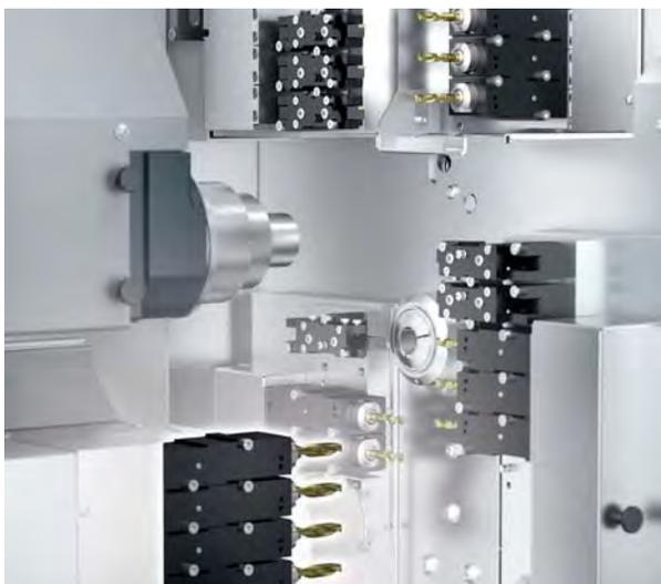
A unidade final da EvoDECO é baseada na cinemática das máquinas de tipo cames e permite assim um aumento da produtividade
