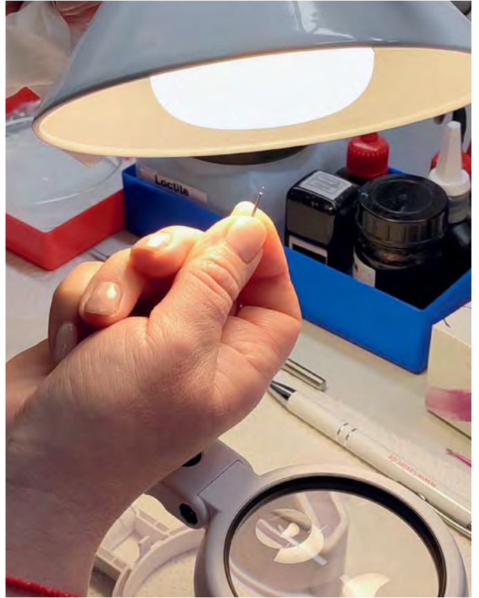
在itp的组装中, 即使是最小的0.15毫米的球体也可以安装。
