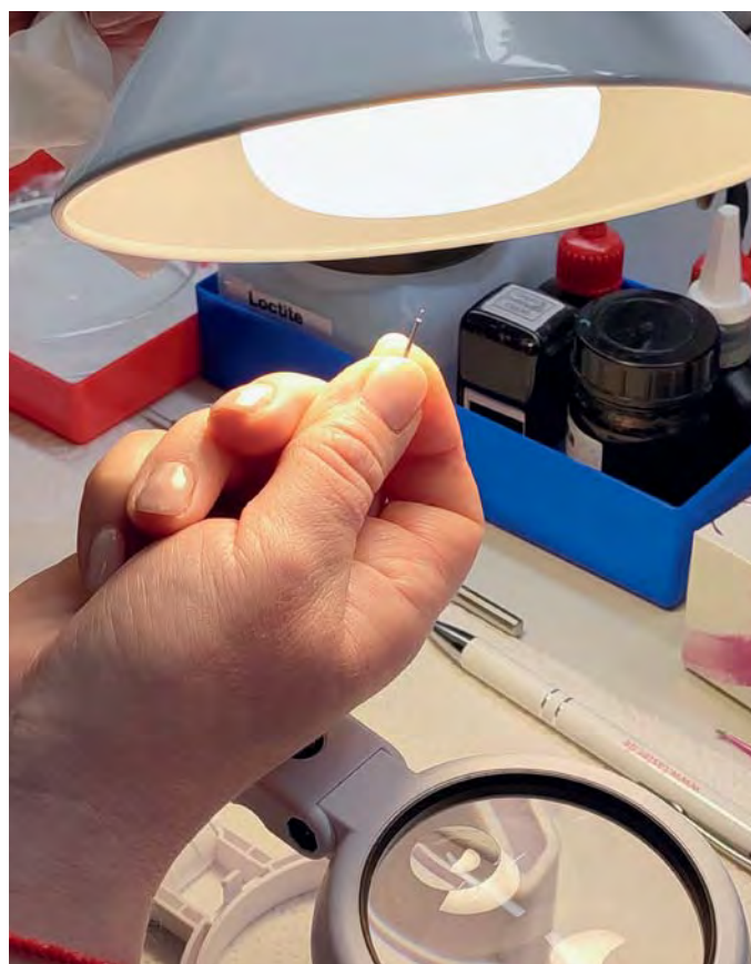
En los procesos de montaje de itp llegan a ensamblarse hasta las bolas más pequeñas, de 0,15 mm.
