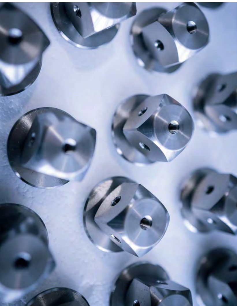
Komponenty wykonane z wysokiej klasy materiałów, takich jak tytan, są obrabiane maszynowo.
