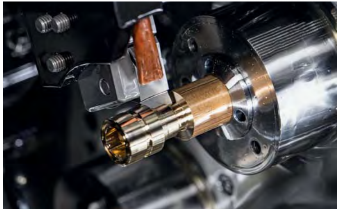
成型槽使用 315 系统制作，该系统的特点是转换精度高。
