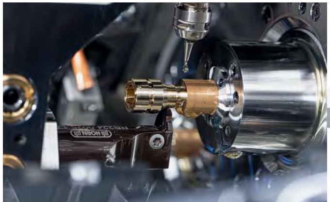
棱镜导向精密可转位刀片 S224 用于螺纹加工。
