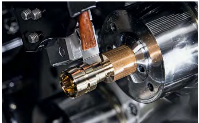
Der Formeinstich erfolgt mit dem System 315, welches sich durch hoher Wechselgenauigkeit auszeichnet.
