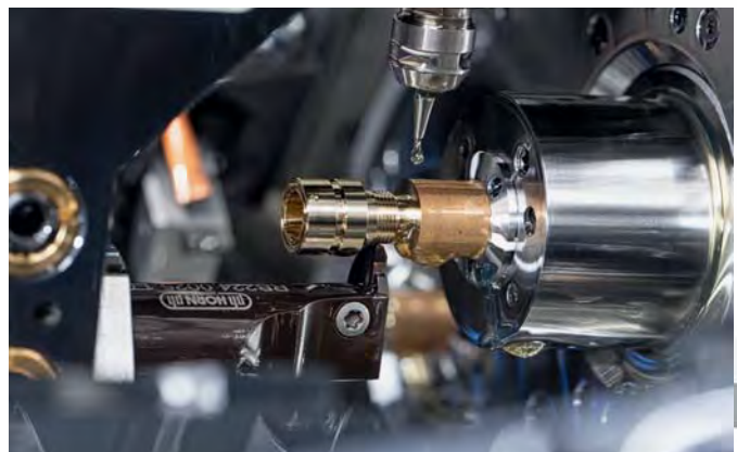
Die prismengeführte Präzisionswendeschneidplatte S224 kommt bei der Gewinherstellung zum Einsatz.
