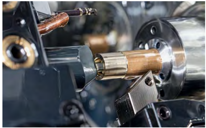
Formeinstich mit System Supermini. Bleifreie Materialien neigen zu langen Spänen, daher wurde die Schneide mit einer Spanformgeometrie ausgestattet.
