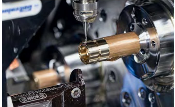
Eine Markierung wird an der Mantelfläche mit dem System DSA angebracht.
