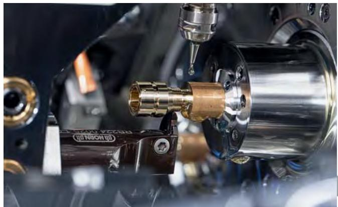
La plaquita de precisión guiada por prisma S224 se utiliza para la producción de roscas.
