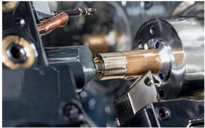
Ranurado con el sistema Supermini. Los materiales sin plomo tienden a producir virutas largas, por lo que el filo de corte se equipó con una geometría de control de virutas.
