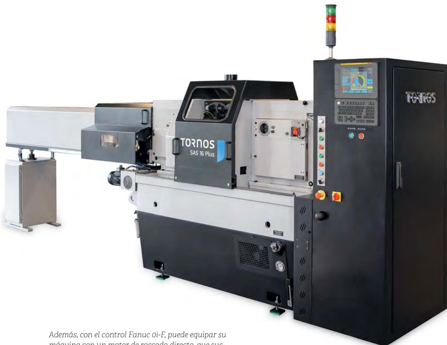
*Además, con el control Fanuc Oi-F, puede equipar su máquina con un motor de roscado directo, que sustituye al dispositivo mecánico de fricción de roscado. Esto significa que puede programar electrónicamente la velocidad de esta operación como desee.*
