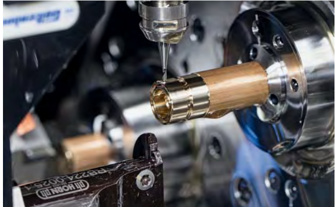
Un marquage est appliqué à la surface externe avec le système DSA.
