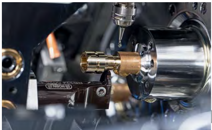
La plaquette de coupe de précision S224 guidée par prisme est utilisée pour la production de filets.
