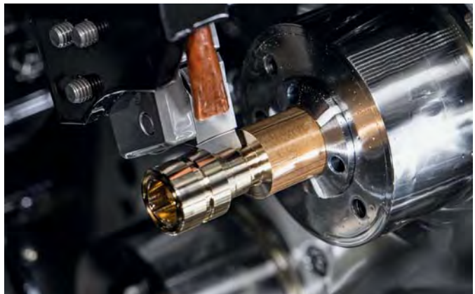
La scanalatura di forma viene realizzata con il sistema 315, che è caratterizzato da un'elevata precisione di cambio.
