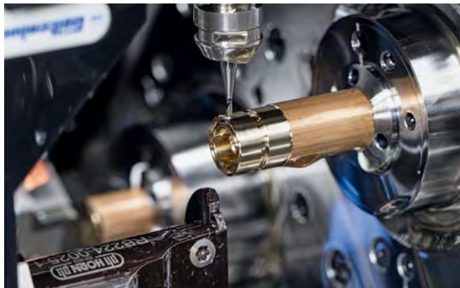
Znak jest wykonywany na powierzchni bocznej za pomocą systemu DSA.
