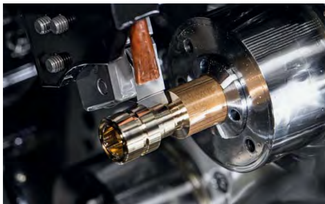
Rowek formujący jest wykonywany za pomocą systemu 315, który charakteryzuje się wysoką dokładnością.
