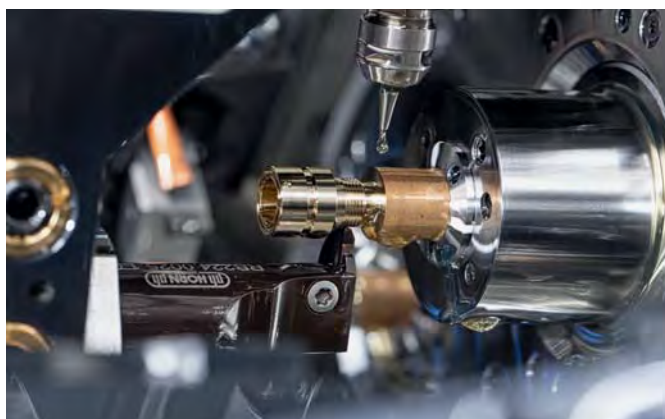
Płytką precyzyjną S224 z prowadzeniem pryzmatycznym jest używana do produkcji gwintów.
