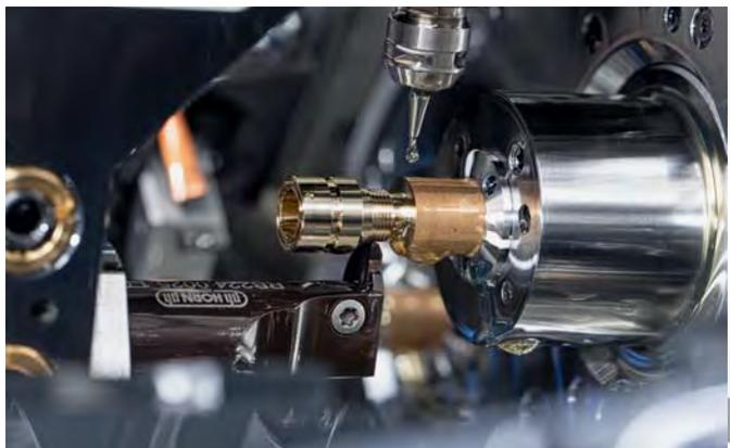
A pastilha de precisão guiada por prisma S224 é usada para a produção de roscas.
