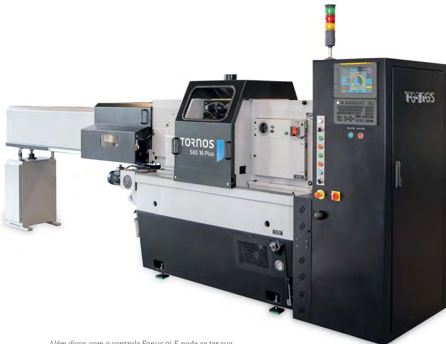
Além disso, com o controle Fanuc oi-F, pode-se ter sua máquina equipada com um motor de rosqueamento direto, que substitui o dispositivo mecânico com fricção de rosqueamento. Isso significa que é possível programar eletronicamente a velocidade dessa operação conforme desejar.
