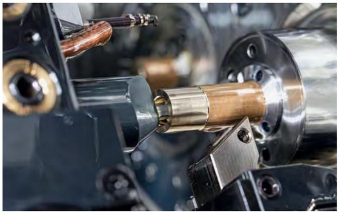
Torneamento interno com Sistema Supermini. Materiais sem chumbo tendem a produzir cavacos longos, por isso a aresta de corte foi equipada com uma geometria de quebra de cavacos.
