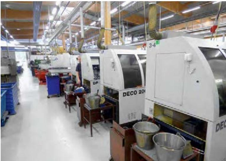
Unter einem Dach: In der klimatisierten Produktionshalle befinden sich rund 50 Werkzeugmaschinen der unterschiedlichsten Generationen. Sämtliche Fertigungsprozesse können mit lediglich 2 Bearbeitungsfluids abgedeckt werden.
