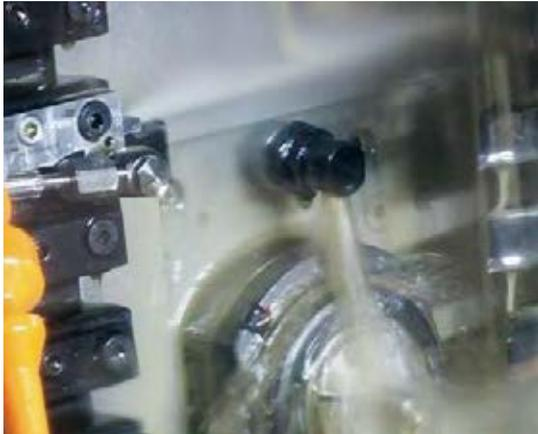
Ablagerung von Metallteilchen im Filtersystem. Dank punktgenauer Zuführung des Schneidöls sorgt Multidec LUBE für einen deutlich geringeren Ölbedarf im Bearbeitungsraum und bewirkt darüber hinaus mit seinem hochgenauen Ölstrahl eine längere Werkzeugstandzeit.
