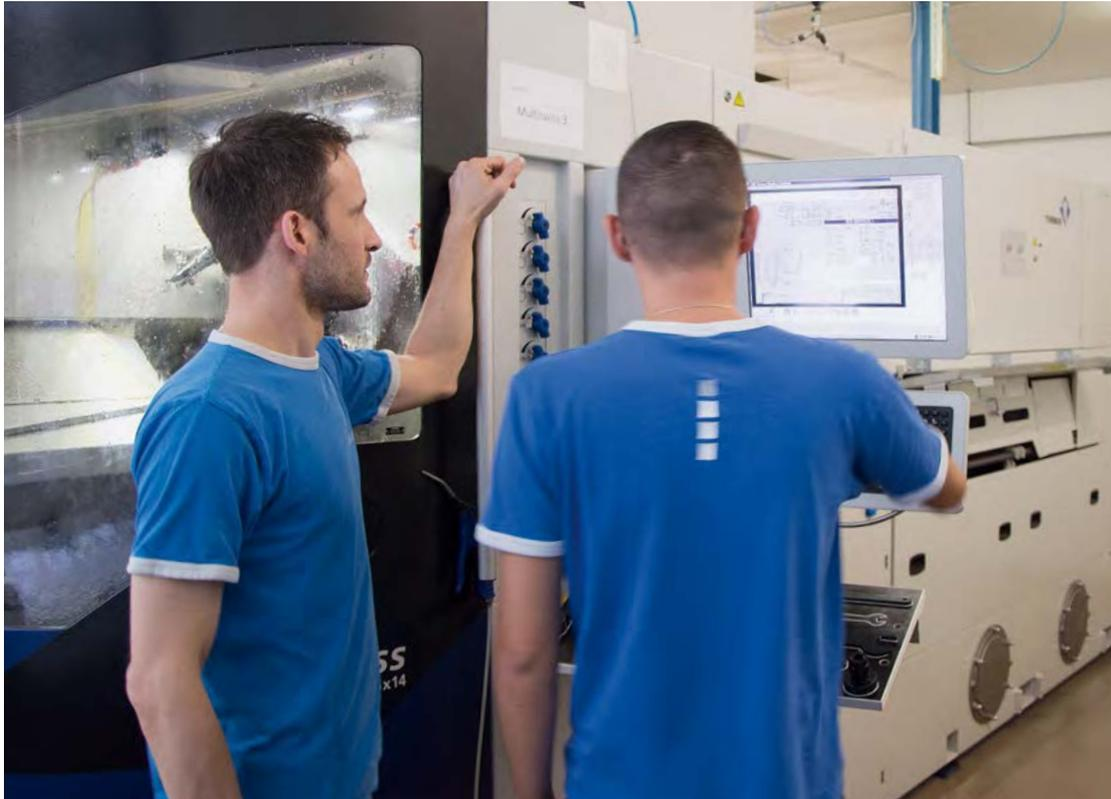
einem klassischen Drehautomaten. Darüber hinaus ist sie besonders gut zugänglich und einfach in der Handhabung. Die Programmierung erfolgt sequentiell; die TB-DECO-Software übernimmt mit höchster Zuverlässigkeit die Synchronisierung, während die Maschine direkt über den dazugehörigen PC programmiert werden kann.
