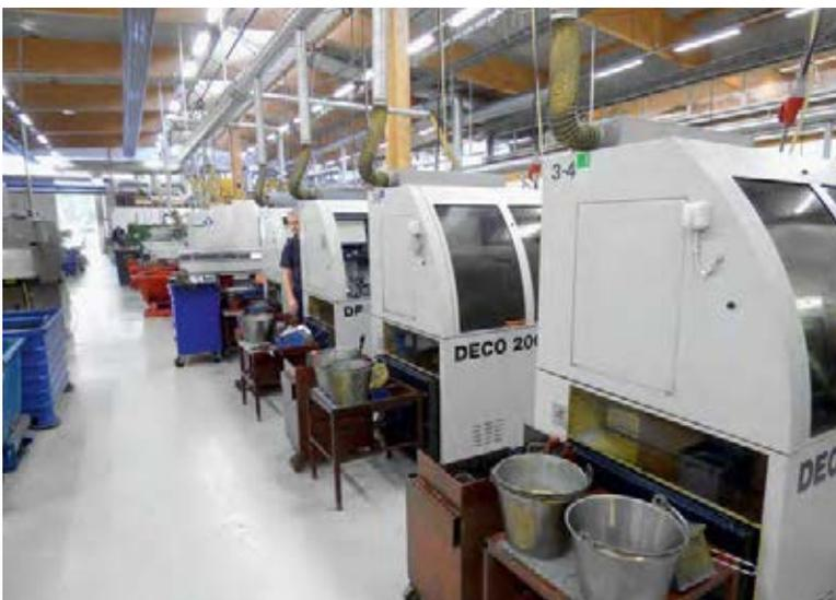
Bajo un techo: La planta de producción equipada con aire acondicionado aloja unas 50 máquinas de distintas generaciones. Solo son necesarios dos fluidos de mecanizado para la gama completa de procesos de producción.
