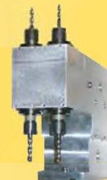
Tête polyvalente de perçage fraisage pour gros usinages avec réducteur de vitesse. Utilisable avec ou sans contre-palier.
