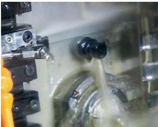
di lavorazione più di 20 volte. Le principali conseguenze sono un'ossidazione e un invecchiamento prematuro dei lubrificanti nonché un accumulo inutile delle particelle metalliche nel sistema di filtrazione. Mirando precisamente la diffusione del liquido da taglio, Multidec LUBE riduce considerevolmente la quantità necessaria nella zona di lavoro e contribuisce a un aumento della durata di vita dei taglienti grazie alla grande precisione dei getti.
