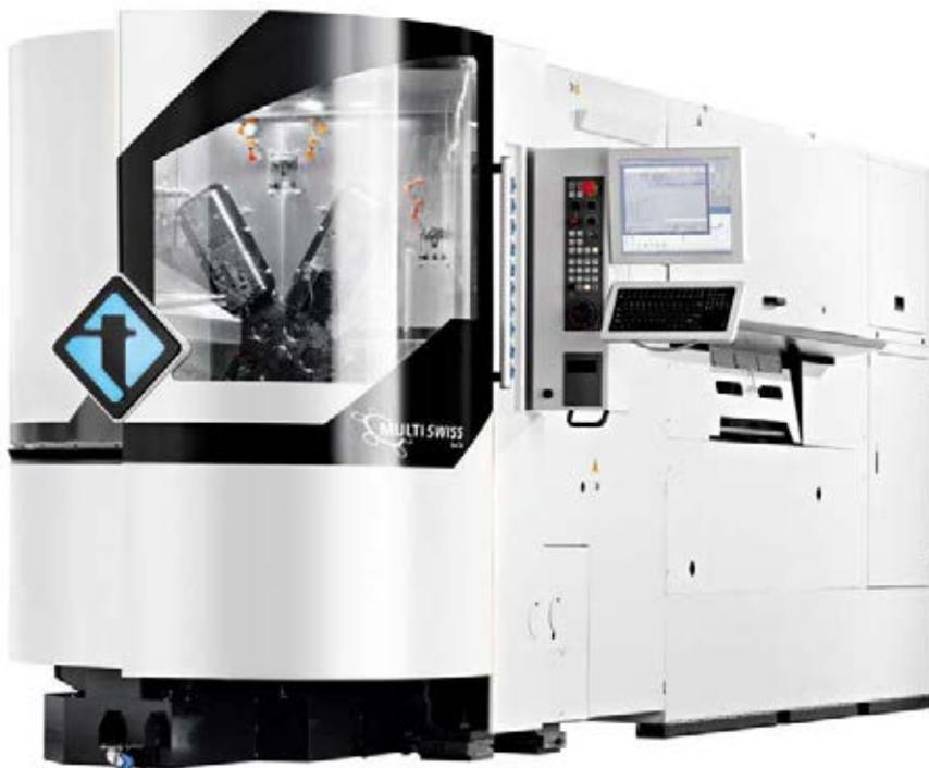
Guter Zugang zum Arbeitsraum, vielfältig vorhandene Werkzeugaufbauten, die optional einsetzbare Y-Achse, mit der das bearbeitbare Teilespektrum sinnvoll erweiterbar ist und der kompakte Aufbau der Maschine mit den Zusatzaggregaten, dies sind die Hauptvorteile der Baureihe.
