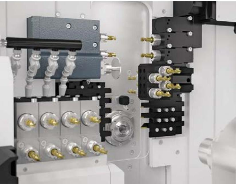
Die Swiss GT 13 ist serienmäßig mit einer Gegenbearbeitung ausgerüstet, deren Y-Achse bis zu 8 Werkzeuge aufnehmen kann. Haupt- und Gegenbearbeitung erfolgen völlig unabhängig voneinander. Spindel und Gegenspindel haben identische Leistungsdaten und bieten deshalb mehr Freiheit beim Programmieren. Vorbei die Tage, wo man sich genau überlegen musste, wo man schwere Bearbeitungsschritte ausführt, weil die Gegenbearbeitung nicht genug Leistung brachte.
