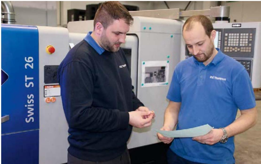
Vorder- und Rückseitenbearbeitung und die einmalige Kinematik der Tornos, bei der die Werkzeuge eng am Werkstück gehalten werden und so die Durchlaufzeiten verkürzt und die Werkzeugschaltzeiten auf unter 0,5 Sekunden reduziert werden können.
