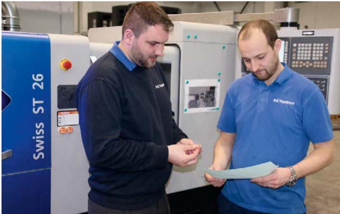
La ST 26 dedicada pulverizó los tiempos de mecanizado anteriores y dejó atrás a la competencia. Ello se debe al mecanizado simultáneo de operación principal y contraoperación y a la cinemática de Tornos, por la cual la herramienta se mantiene cerca de la pieza con el fin de acortar los tiempos de ciclo y realizar la indexación de la herramienta en menos de 0,5 segundos.
