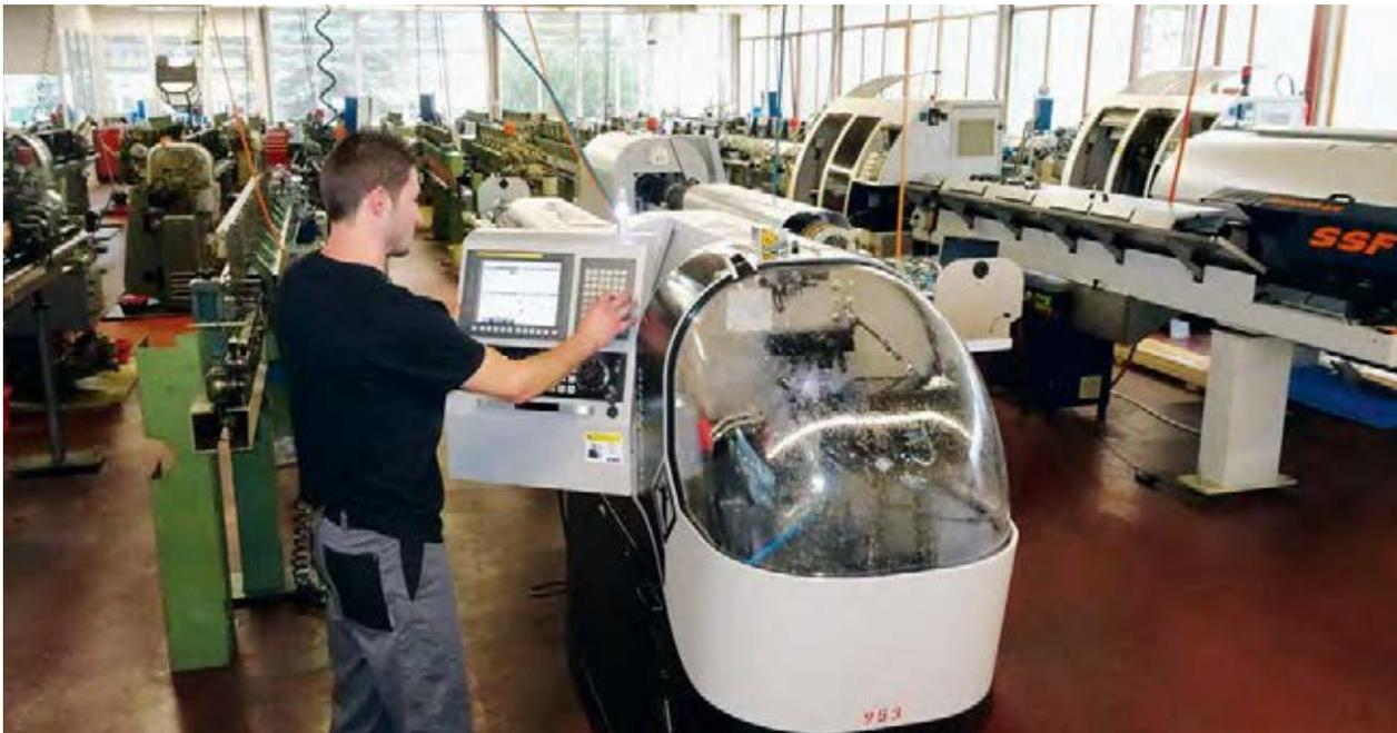
La machine **SwissNano** a vite trouvé sa place au sein de l'atelier. Bien que spécialisé sur machines **Deco**, le décolleteur programmant et travaillant avec la machine s'y est rapidement adapté et la capacité de production de l'atelier s'en est trouvée complétée.
