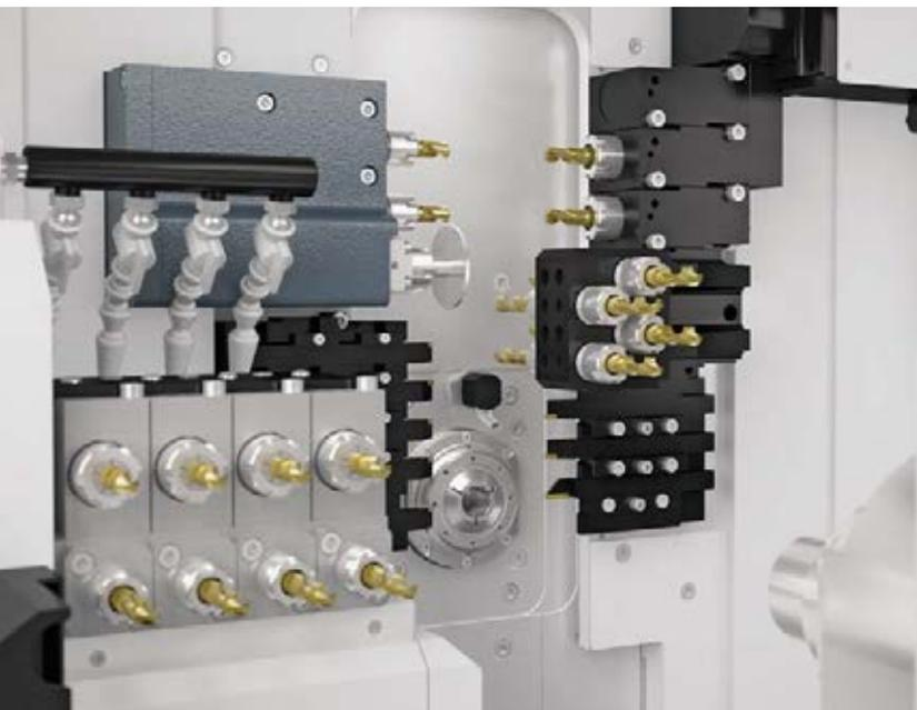
O Swiss GT 13 tem como padrão uma estação de operação bilateral equipada com um eixo Y que consegue abrigar oito ferramentas. As operações e as contraoperações são executadas completamente de forma independente entre si. Aumentando a sua liberdade de programação estão os fusos e contra-fusos desta solução com classificações de potência idênticas, então você pode dizer adeus aos dias de operações com barras pesadas devido à alimentação insuficiente em contraoperações.
