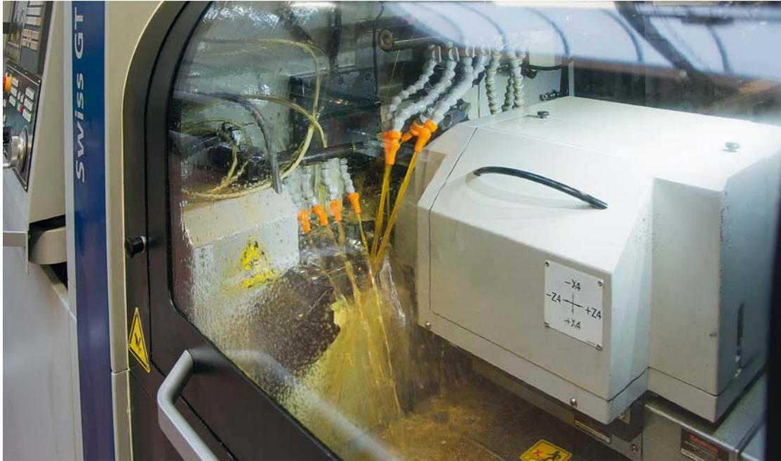
Eine Swiss GT 13 bei der Bearbeitung einer Schraube mit Sollbruchstelle.
