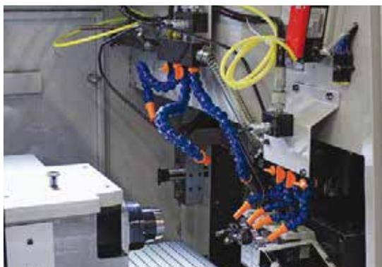
Blick in den Arbeitsraum einer Tornos CT 20 mit einigen der zahlreichen Achsen. Links die CNC-gesteuerte Gegenspannzange für die Rückseitenbearbeitung.
