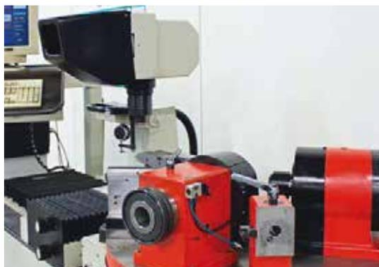
Die in der Einrichtung präzise voreingestellten Werkzeuge lassen sich später in der Maschine mit wenigen Handgriffen einrüsten.
